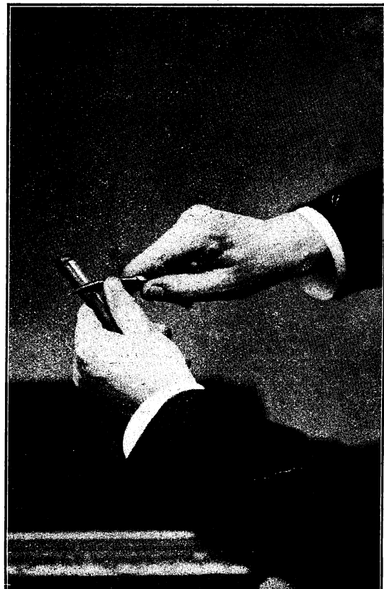
Incision faite au milieu du roseau pour permettre de le plier.
